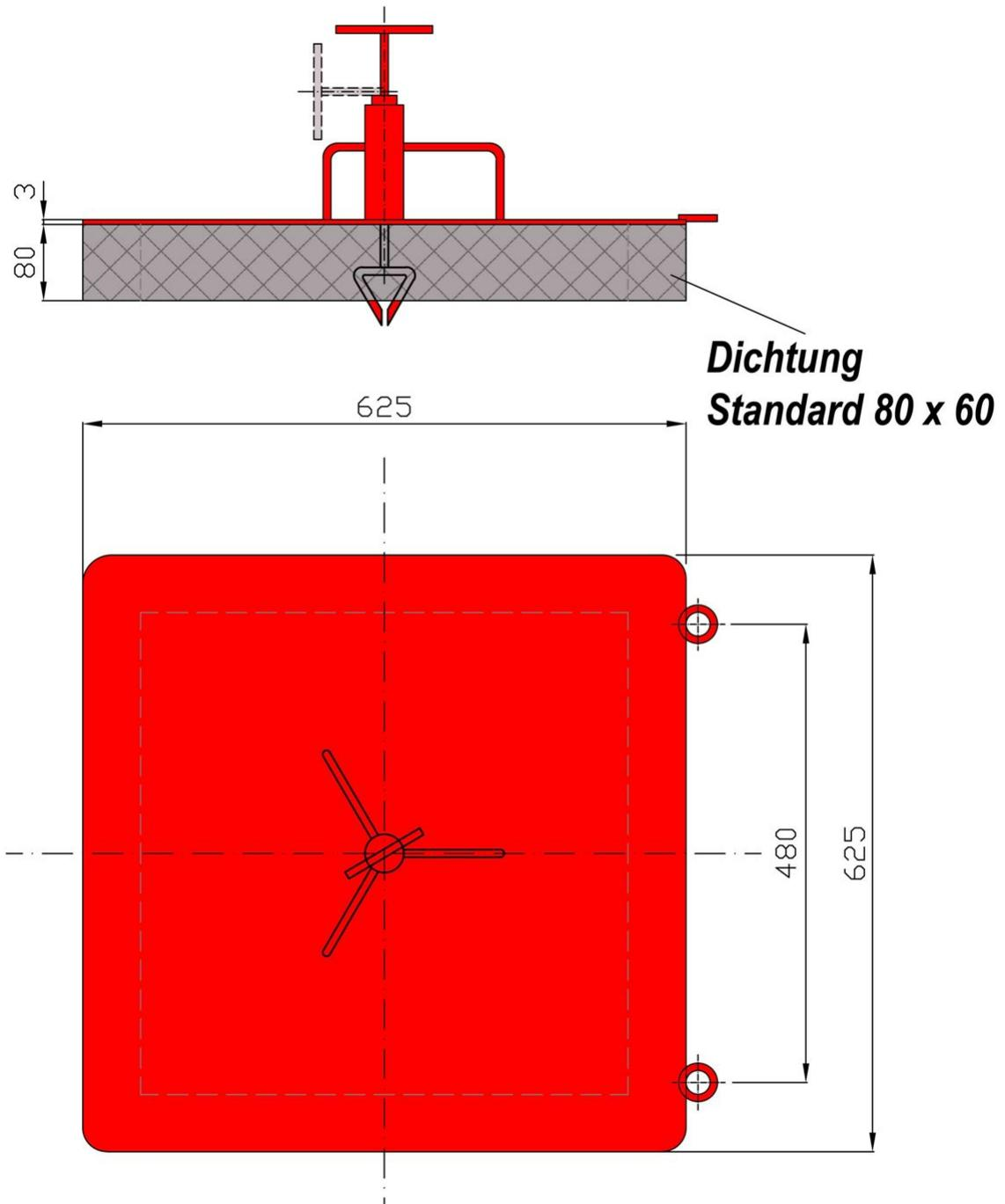
**BL/KSP (Kanaleinlauf-Abdeckung, Spannsystem Federkraft)**
